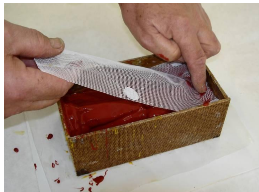
Vkládání výztuže do třetí vrstvy
